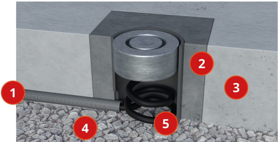
Příklad instalace čidla teploty a vlhkosti do povrchu
